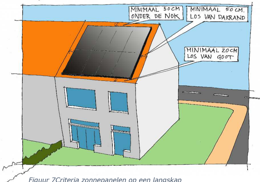
Figuur 7 Criteria zonnepanelen op een langskap
